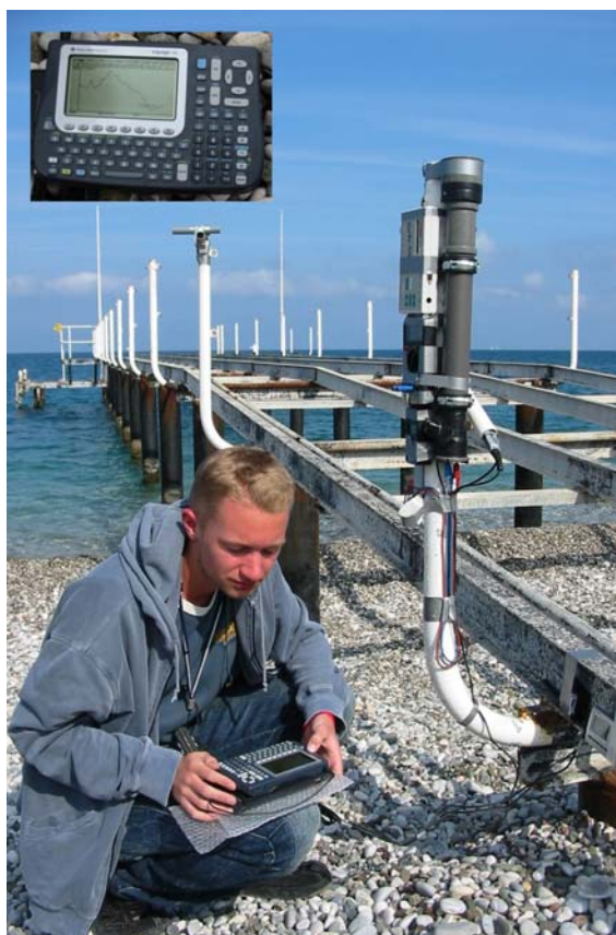
Abb. 2: Unsere klimageographische Messstation am 29.03.2006: Die Sensoren für Temperatur, Luftdruck und Luftfeuchtigkeit sind rechts unten im Schatten montiert, am Metallpfahl die Helligkeitsmessgeräte.
